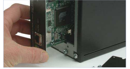
APC'nin standart ya da opsiyonel kartlarını SmartSlot yuvalarına takarak ek denetim imkanları sağlayabilirsiniz. SURT XL 5000, 7500 ve 10000 modellerinde; bu yuvada standart olarak Web/SNMP Kartı takılmış durumdadır.
